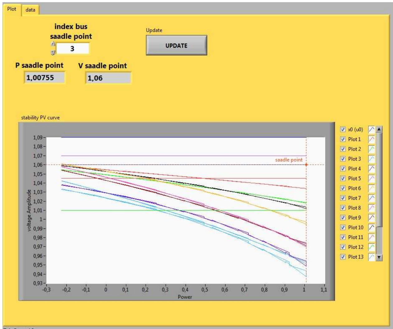
Figure 4.6 : l'Interface graphique du logiciel Labpower pour l'analyse de stabilité par la courbe PV
