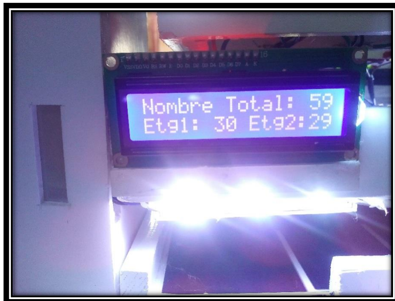
Figure III.12.4 : L'afficheur LCD en cas d'entrée d'une voiture
