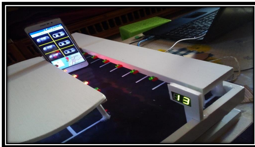
Figure III.13.1 : La présence des véhicules dans trois places sur le bloc B.
