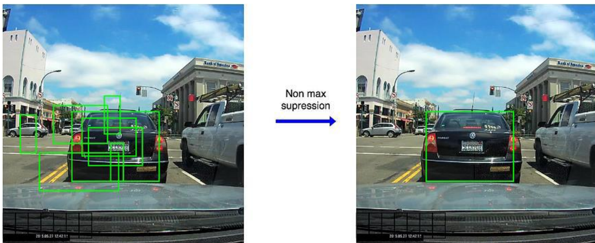
Figure III.4:Application de la suppression non maximale (Non Max Suppression) pour la détection d'objet
