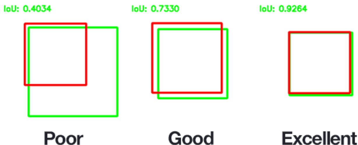
Figure III.6: Un exemple de calcul d'intersection sur des unions pour différentes boîtes englobantes.
