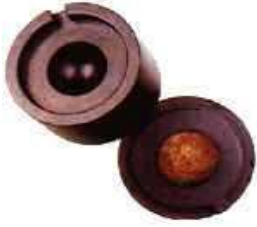
شكل رقم (08) يمثل الطابع الذي تصنع به الكرة
