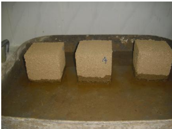
Figure VI.19: Essai d'absorption par capillarité sur bloc pisé à 10 min et 24h.
