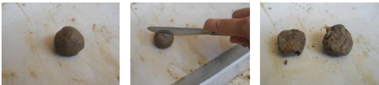
Figure VI.03: Essai de l'éclat [Auteur].
