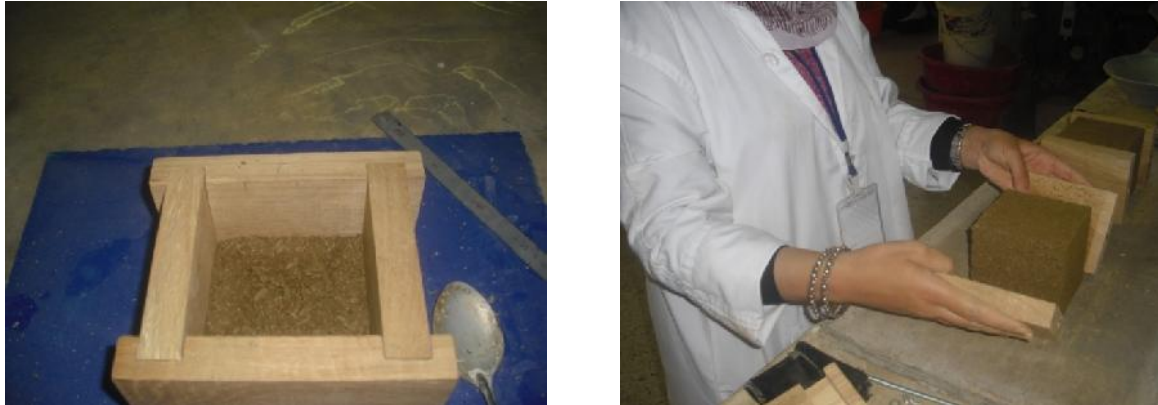
Figure VI.16: Compactage et genèse des corps d'épreuves.
