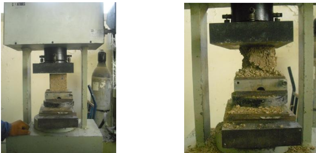
Figure VI.17: Essai d'écrasement sur corps d'épreuves posés à plat.
