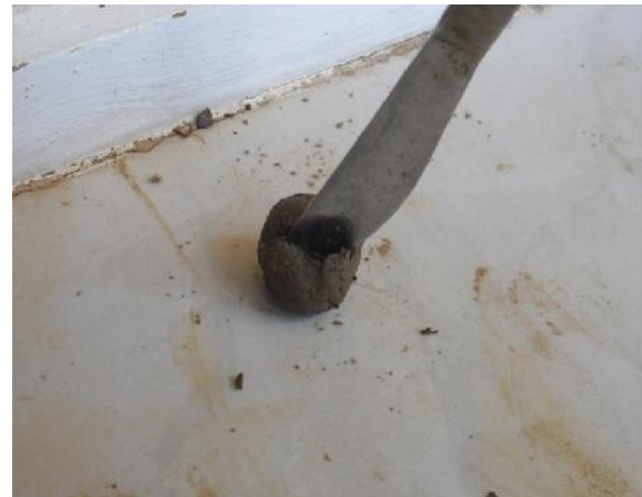
Figure VI.05: Essai d'adhérence [Auteur].
