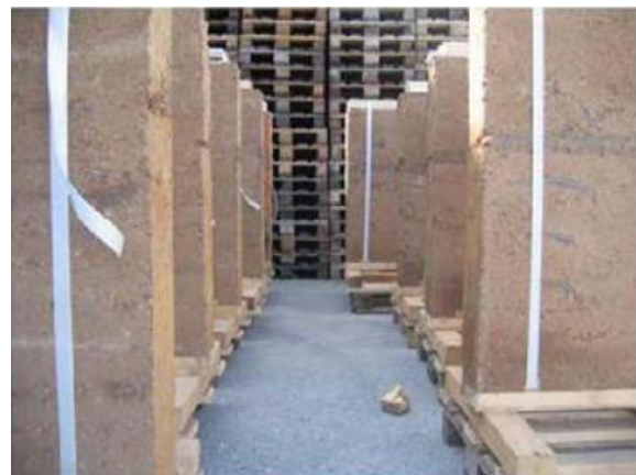
Figure III.24: Préfabrication du pisé dans une usine, en Autriche [Rauch, 2007].
