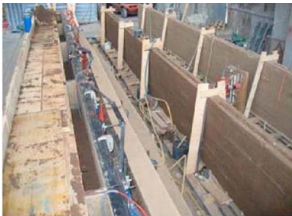
Figure III.24: Préfabrication du pisé dans une usine, en Autriche [Rauch, 2007].
