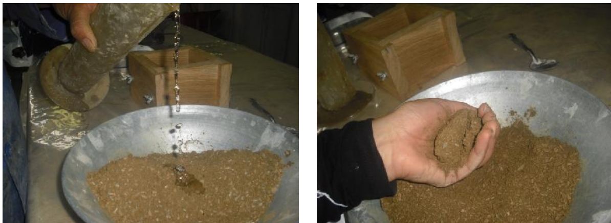
Figure VI.15: L'addition de l'eau de gâchage.
