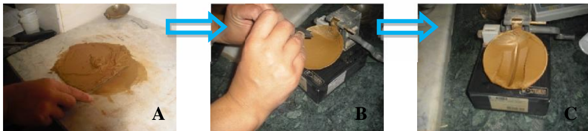
Figure VI.13: Etapes de l'essai des limites selon Atterberg.
