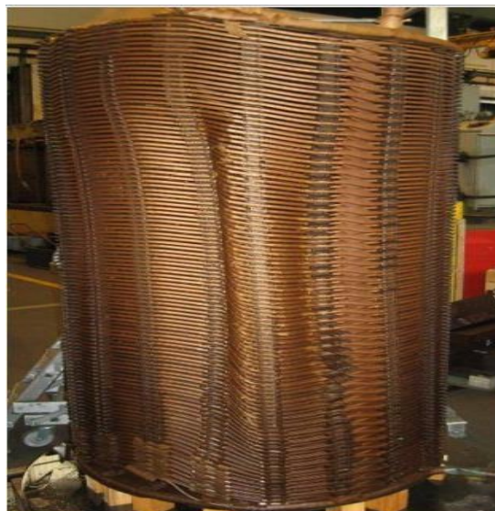
Figure II.6. Déformation géométrique des enroulements
