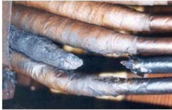
Figure II.5 : Coupure du circuit électrique
