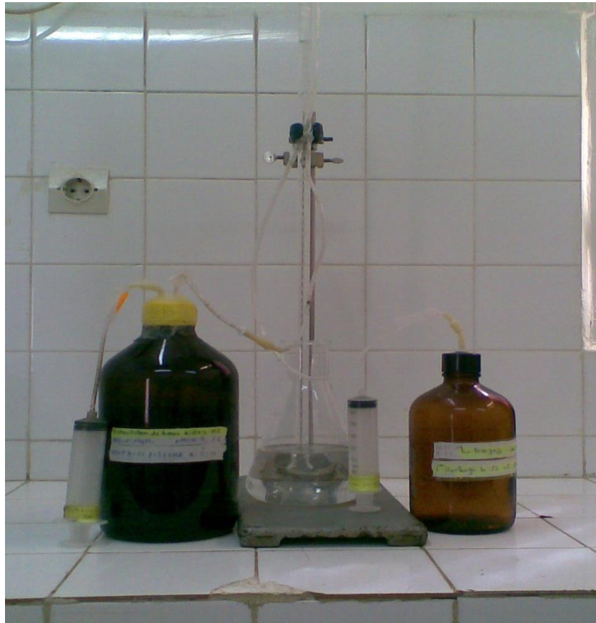
Photographie III-1. Dispositif expérimental d'un digesteur à l'échelle laboratoire.
