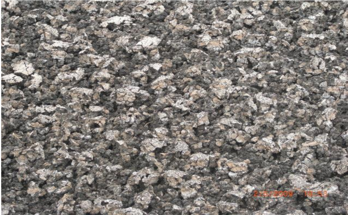
Photographie I-10. Aspect de boue solide sur un lit de séchage en STEP a HR
