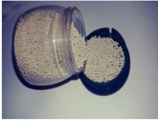
Figure I.6: Zéolite 13X extrudée de différentes tailles
