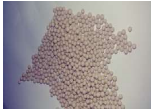
Figure I.6: Zéolite 13X extrudée de différentes tailles
