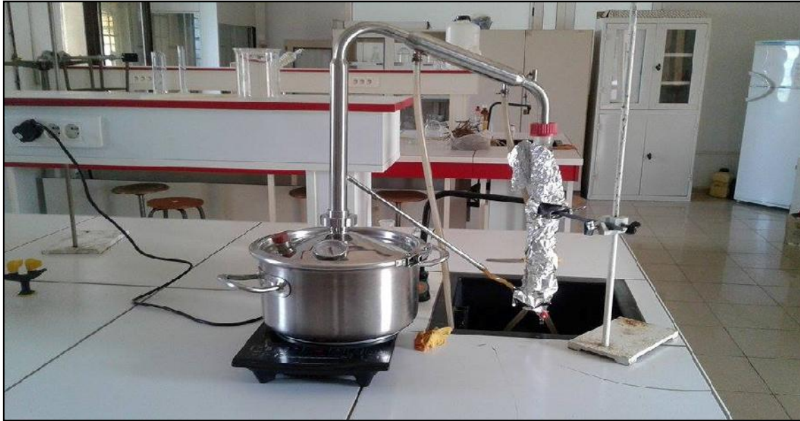
Figure 14: Appareillage utilisé pendant la distillation d'huile essentielle (laboratoire de Biochimie N°01 au niveau de faculté SNV université Abdelhamid Ibn Badis Mostaganem).
