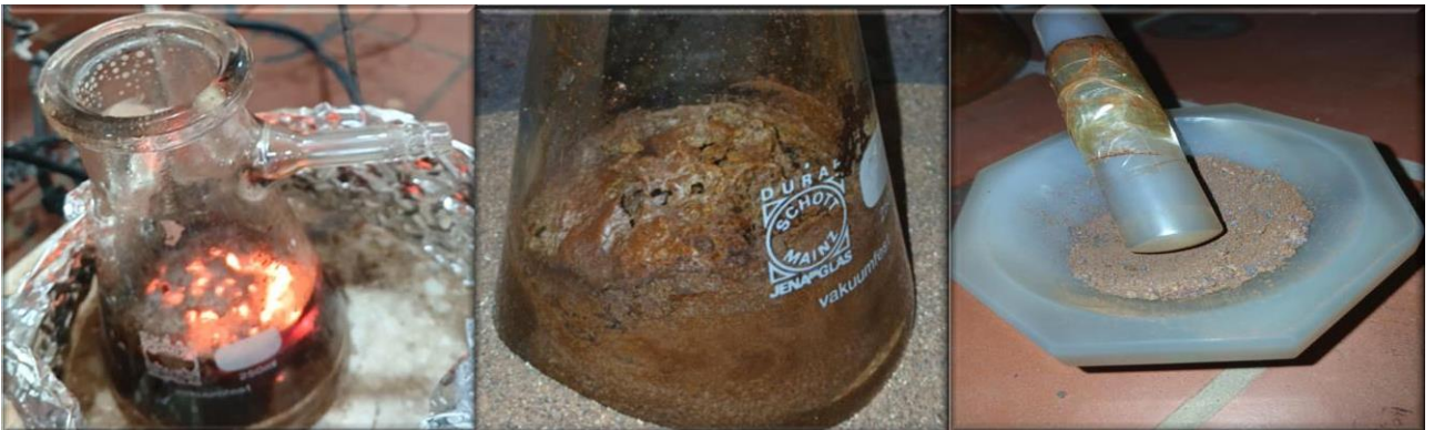
Figure II-3 : photographie illustre les étapes de synthèse de nanoferrite de calcium dopé aux terres rares
