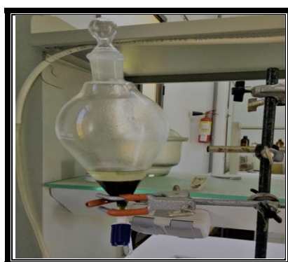
Figure 23 : la séparation des deux phases
