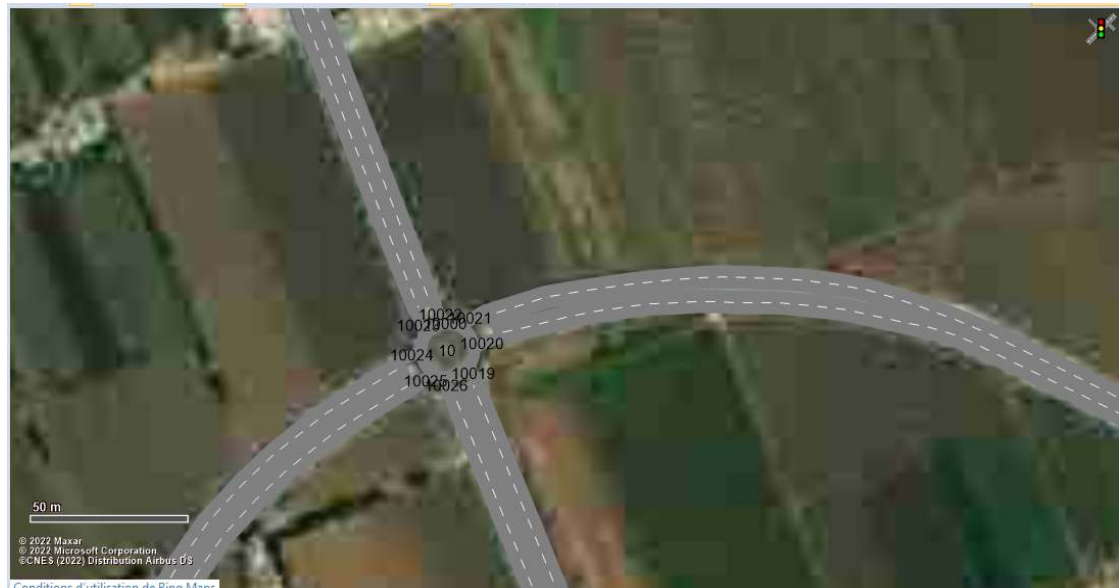
Figure N°2. Réseau VISSIM du carrefour Nord de Meftah, Wilaya de Blida.
