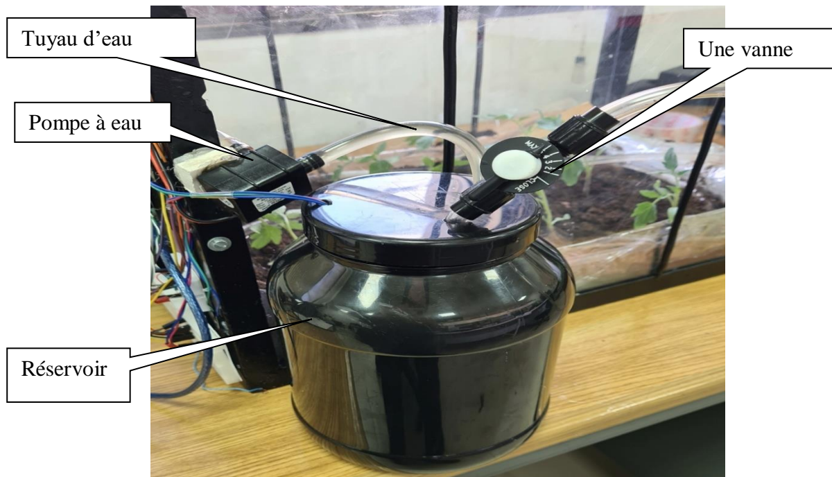
Figure III.10 réservoir avec les équipements
