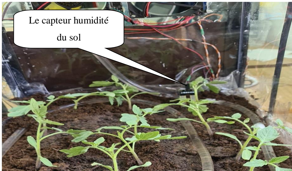
Figure III.8 l'emplacement du capteur du sol dans la serre
