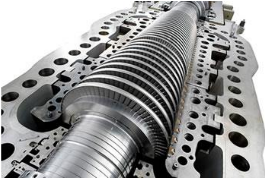
Figure 9 : Turbine à vapeur
