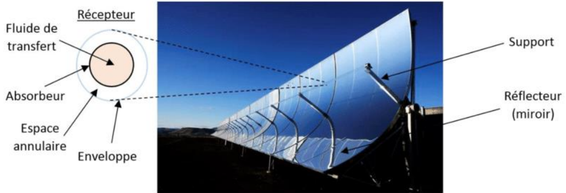
Figure 3 : Capteurs cylindro-paraboliques (CSP)
