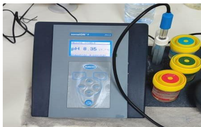
Figure 5 : Mesure du pH d'un échantillon d'eau.
