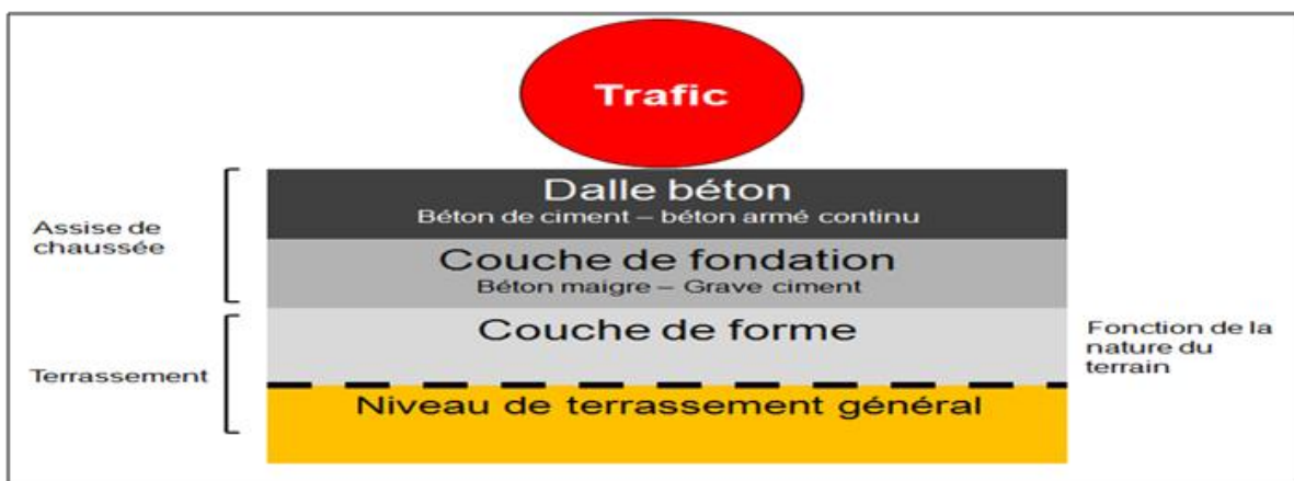
Figure VII.3 : Structure type d'une chaussée rigide.
