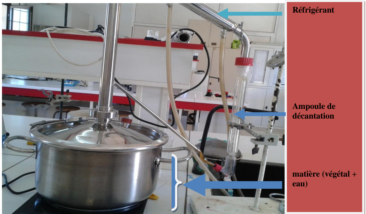
Figure 04: Dispositif d'extraction de l'huile essentielle « entrainement à la vapeur ».
