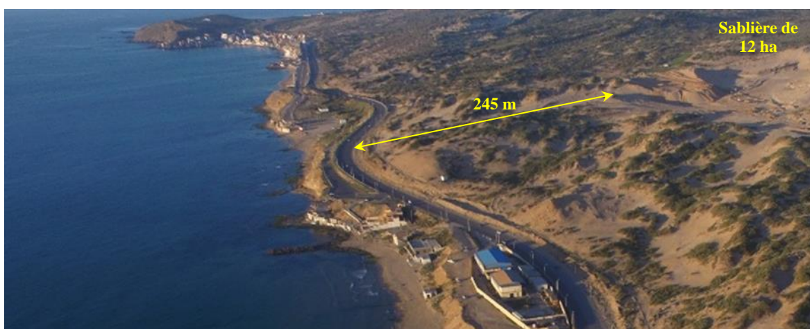
Figure 49 : Extraction de sable le long du flanc ouest du cordon dunaire de Boousfer et Aïn el Turck. L'extraction de sable a certainement mis en danger l'équilibre écologique du cordon dunaire de Bousfer et Aïn el Turck, en perturbant la dynamique éolienne. Il en résulte un transport sédimentaire, suivant la direction du vent dominant du secteur nord-est, étant le plus influent
