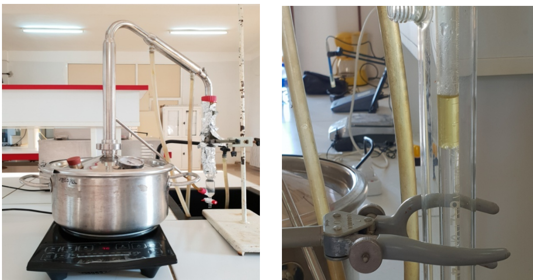
Figure(17) : Hydro distillateur de type entraînement à la vapeur d'eau pour l'extraction de l'huile essentielle ( Originale, 2019 ).
