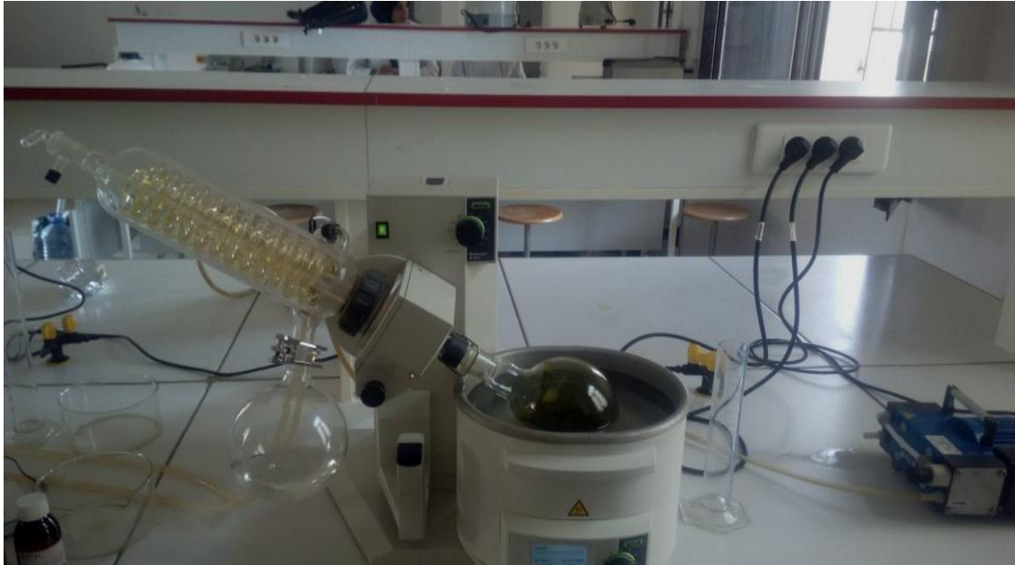
Figure 5. Évaporation du solvant (eau) sous vide par Rota vapor (Amara, 2019).
