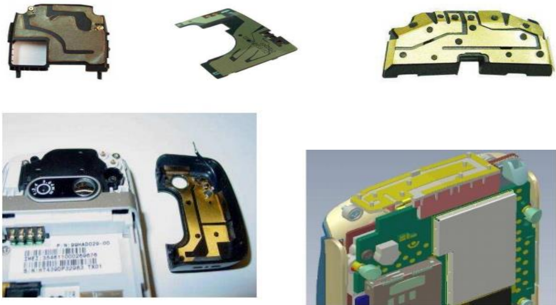
Figure 40: Exemples d'antennes PIFA présentés dans des téléphones portables [14].
