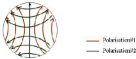
Figure 31: Illustration de deux polarisations différentes pour des applications de diversité de Polarisation.
