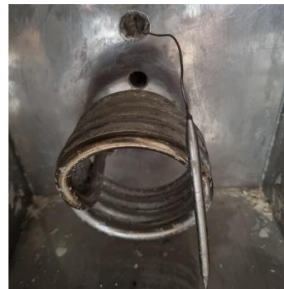
Figure 3.4 : a) deux Contacteurs GMC-22 b) Résistance bobinée (16Ω) et sonde du thermostat
