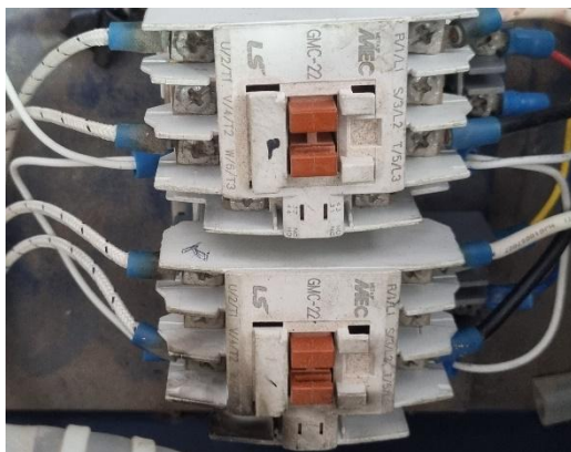
Figure 3.4 : a) deux Contacteurs GMC-22 b) Résistance bobinée (16Ω) et sonde du thermostat
