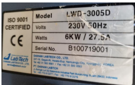
bi-distillateur d'eau inox automatique – 4L/h ref : LWD-3005D
