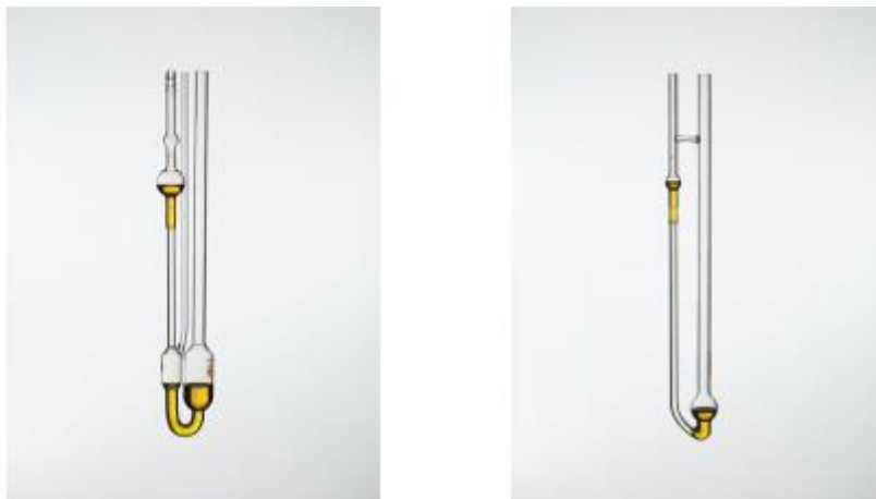
Figure 2.2 : Viscosimètre capillaire de type Ubbelohde (gauche) et Ostwald (droite)
