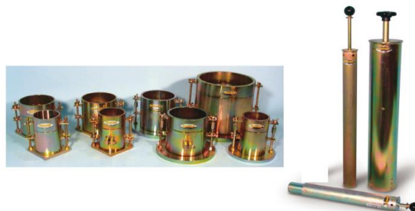
Figure VI.4. Matériel utilisé dans l'essai Proctor.
