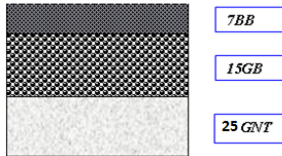
Figure VII.3. Schéma de la chaussée (méthode CBR).
