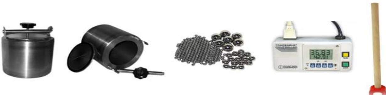
Figure VI.7. Matériel utilisé dans l'essai Micro-Deval.
