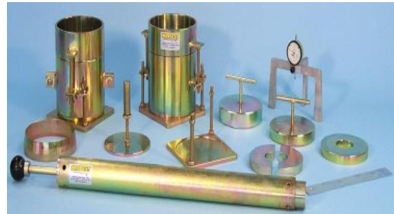
Figure VI.5. Matériel utilisé dans l'essai CBR.
