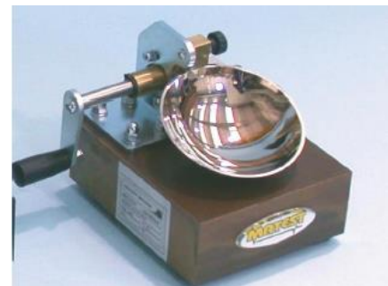
Figure VI.2. Matériel utilisé dans l'essai Limites d'Atterberg.
