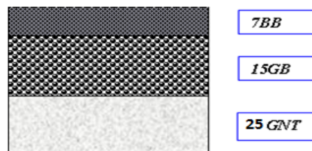
Figure VII.7. Schéma de la chaussée (méthode CBR).
