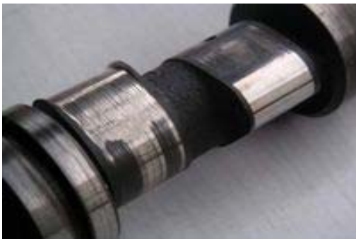
Fig.(1.3) : Usure sur arbre à cames
