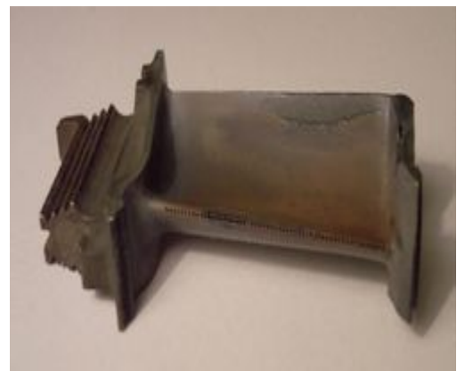
Fig.(1.18): Usure Aube de turbine à gaz
