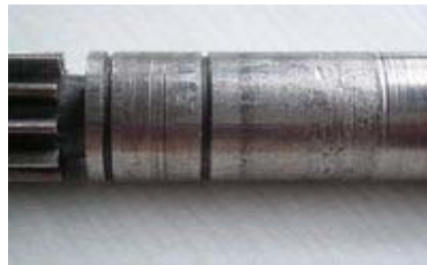
Fig.(1.10): Usure d'une tourillon
