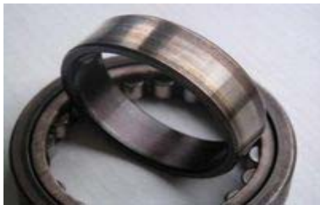
Fig.(1.9): Usure d'un roulement
