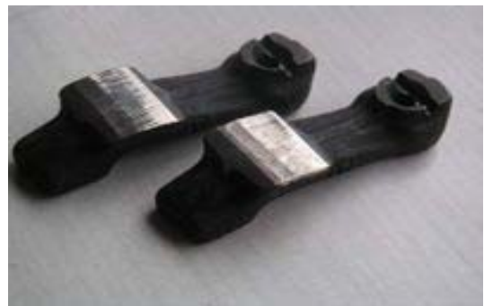
Fig.(1.4) : Usure sur un poussoir
