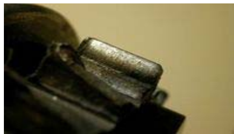
Fig.(1.11): Usure d'un pignon de boîte de vitesses d'une motocyclette
