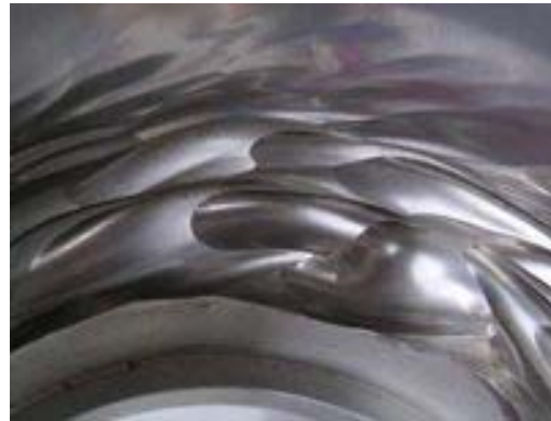
Fig.(1.16): Virole d'acier inoxydable usée par érosion
