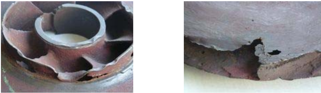
Fig.(1.19): Impulseur de pompe centrifuge
