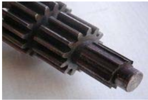
Fig.(1.8): Usure sur des dentures d'un arbre de boîte à vitesses
