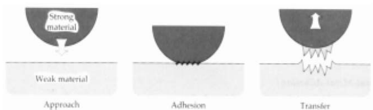
Fig.(1.12): Schéma de l'usure adhésive. Le matériau adhère à la surface antagoniste et lui arrache de la matière.[9]
