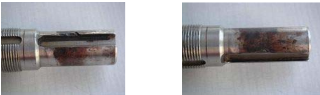
Fig.(1.13): Usure constaté sur une bague de roulement
