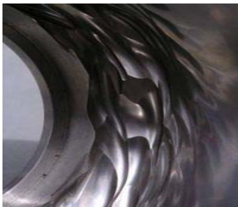
Fig.(1.17): Usure d'une conduite. usée par érosion
