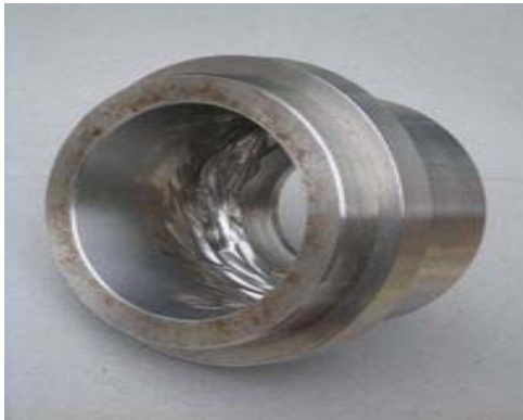
Fig.(1.16): Virole d'acier inoxydable usée par érosion
