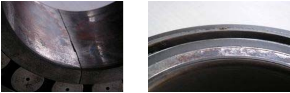
Fig.(1.13): Usure constaté sur une bague de roulement
