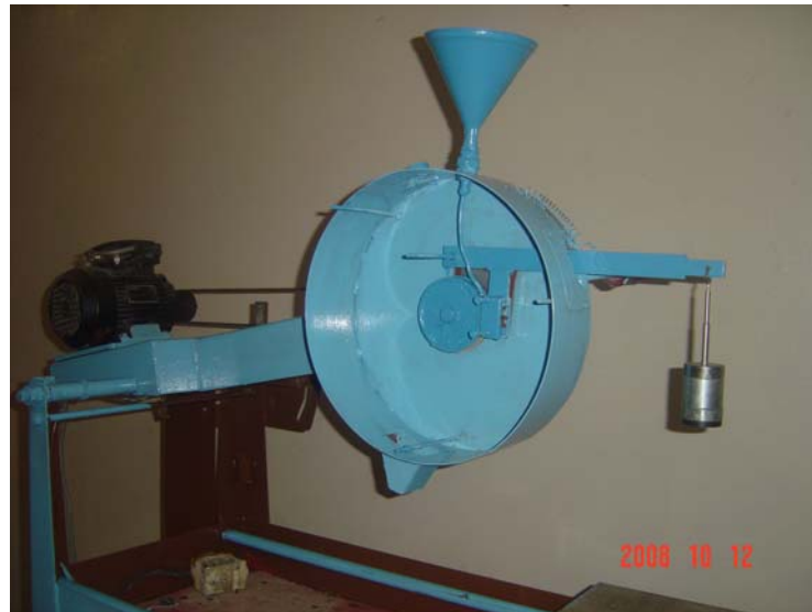
Fig. (3.2): Photo du banc d'essai d'usure abrasive
