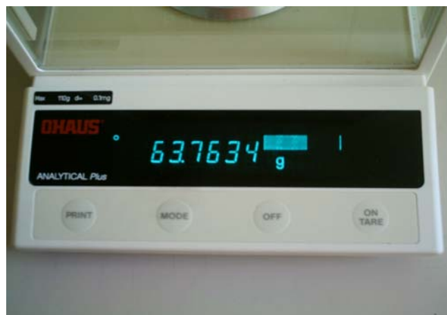
Fig.(3.4): Cadran de Lecture (précision 10^{-4} g)
