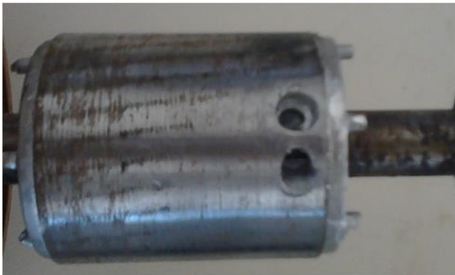
figure III- 17: Rotor défectueux avec deux trous
