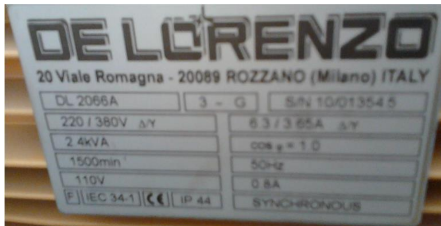
Figure A- 3:la plaque signalétique de la génératrice
