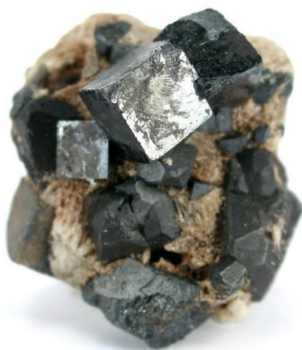
Fig. I.1. Cristaux naturels de pérovskite ( CaTiO_3 ) sur matrice[23]
