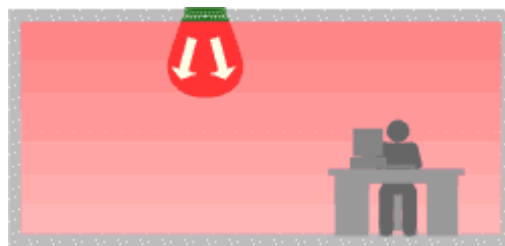
Figure I.5 : Soufflage chaud vertical détruisant la stratification.
