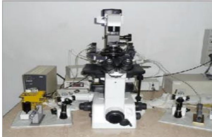
Figure 10 : microscope inversé doté de micromanipulateur joystick(photo : Denis NECCI, ; 2017)
