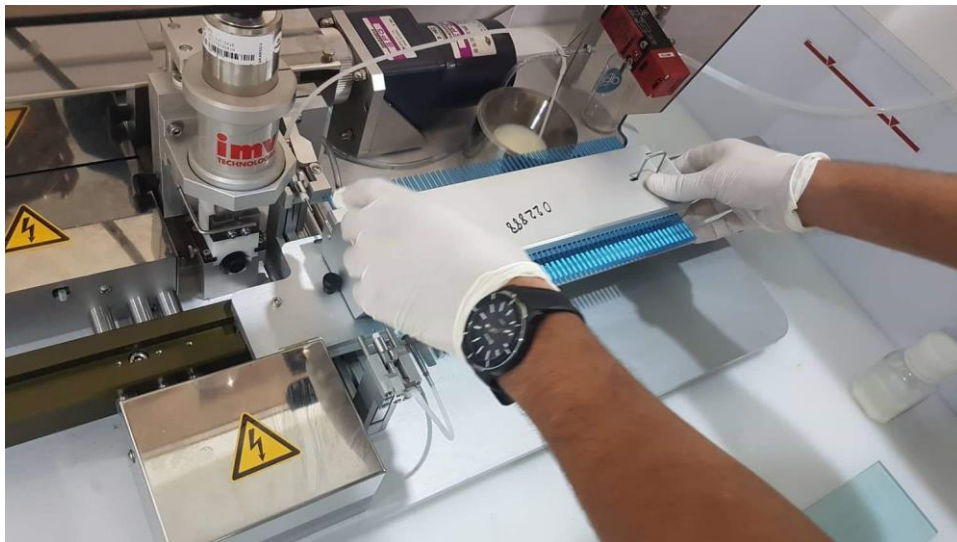
Figure27 : Machine à remplir et a souder MRS I
