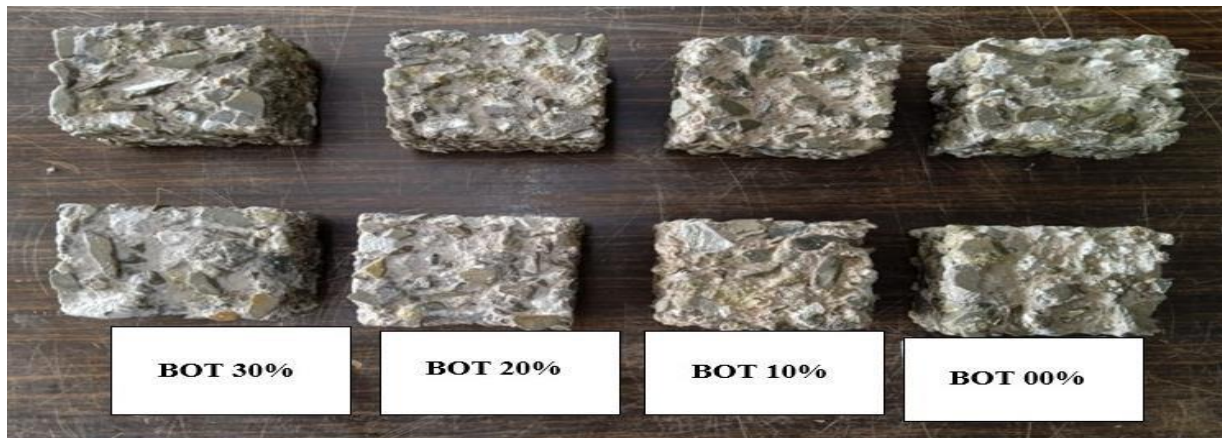
Figure IV.12 : Dégradation des échantillons du béton après 12 semaine d'immersion dans la solution d'acide sulfurique
