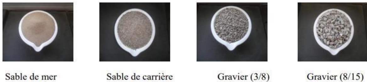
Figure IV.1 : Les granulats utilisés pour la confection de nos bétons [82]
