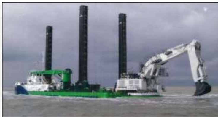
Figure II.11 : dragues rétro caveuses [54].
