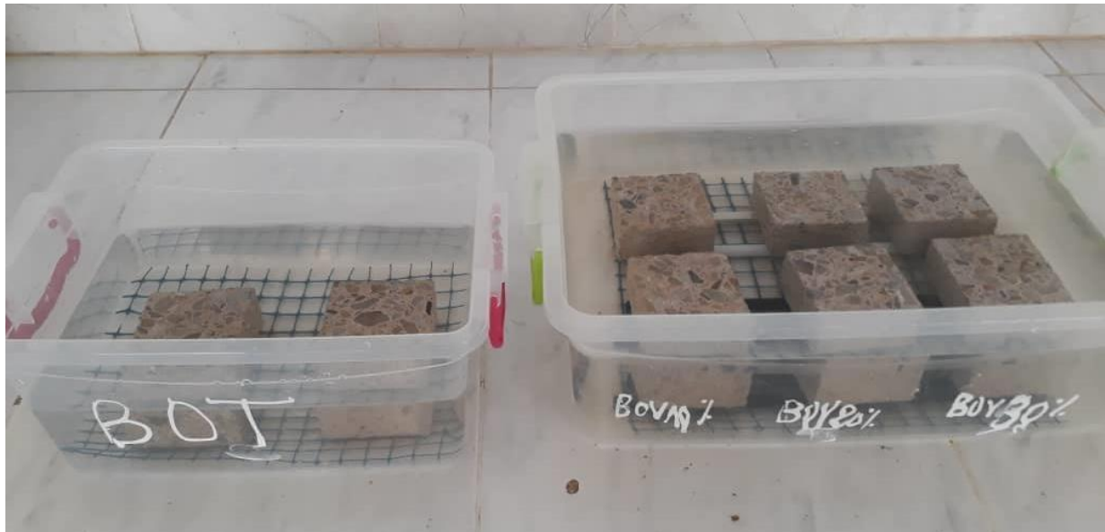
Figure IV.5 : Conservation des échantillons de béton dans la solution H_2SO_4 à 2 % de concentration
