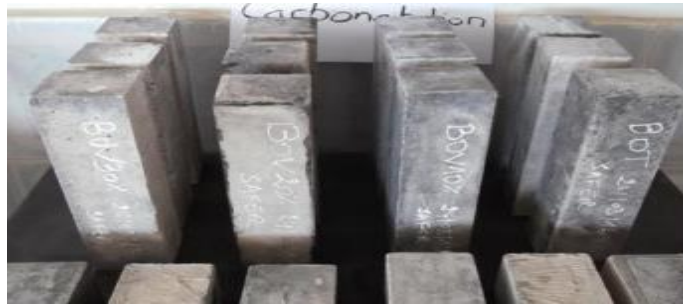
Figure IV.7 : Les éprouvettes destinées à la carbonatation naturelle
