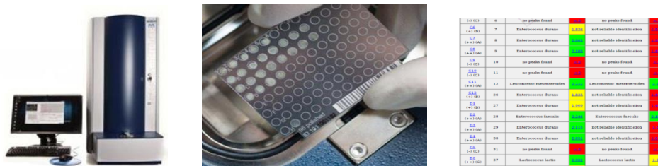
Figures02: Identification au MALDI TOF Bruker (l'appareil – la plaque cible — tableau des résultats
