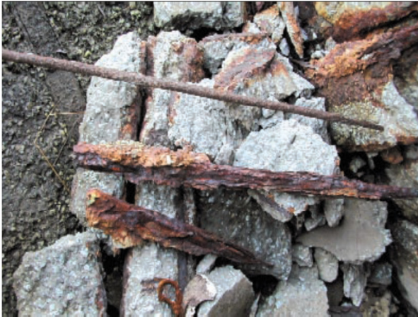
Fig. II.10 : En se corrodant, les aciers
