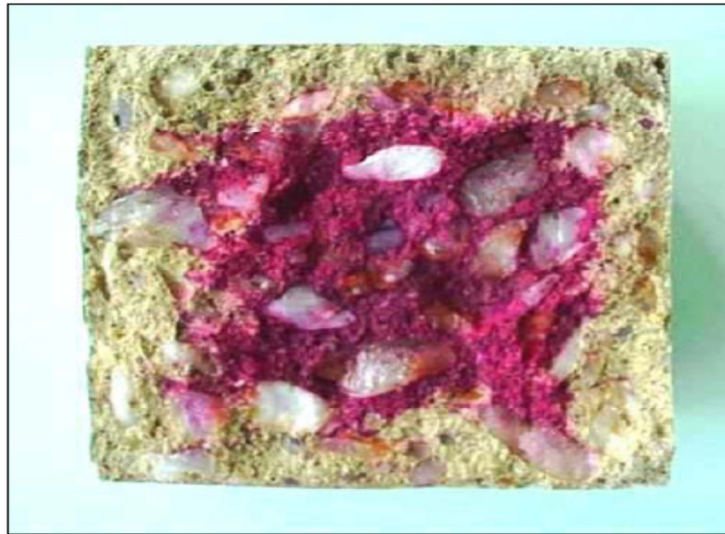
Fig. II.7: Exemple d'échantillon carbonaté (7x7x28 cm)
