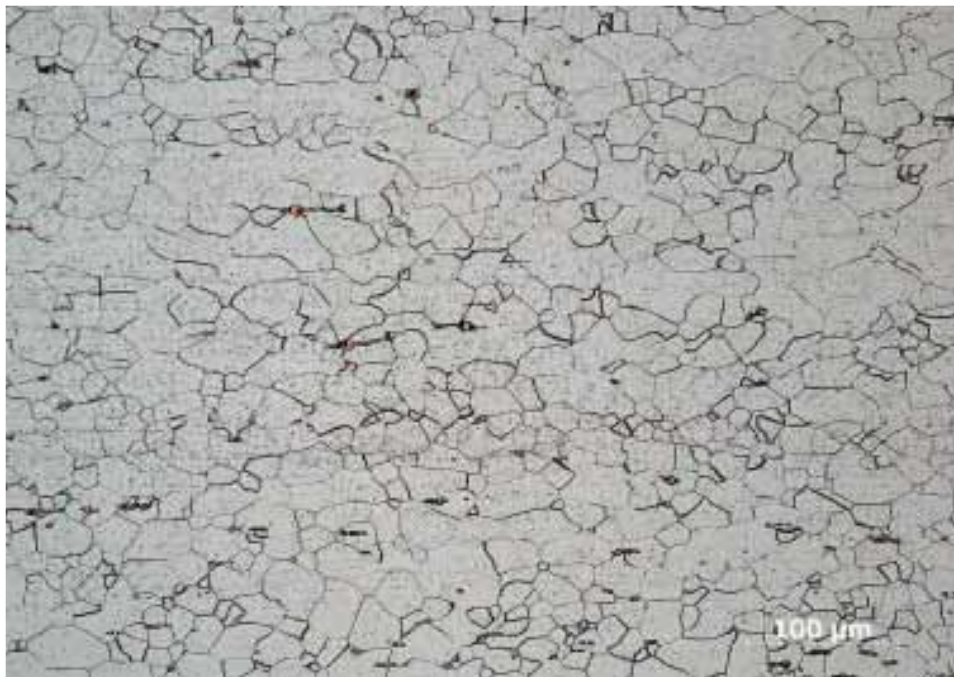
FigII.3 métallographie d'un acier inoxydable ferritique. [6]
