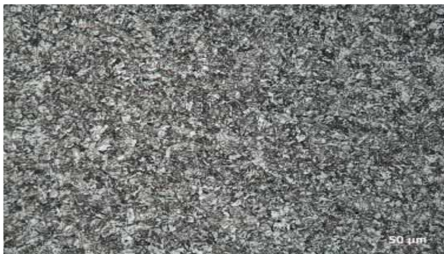
FigII.4 métallographie d'un acier martensitique. [6]
