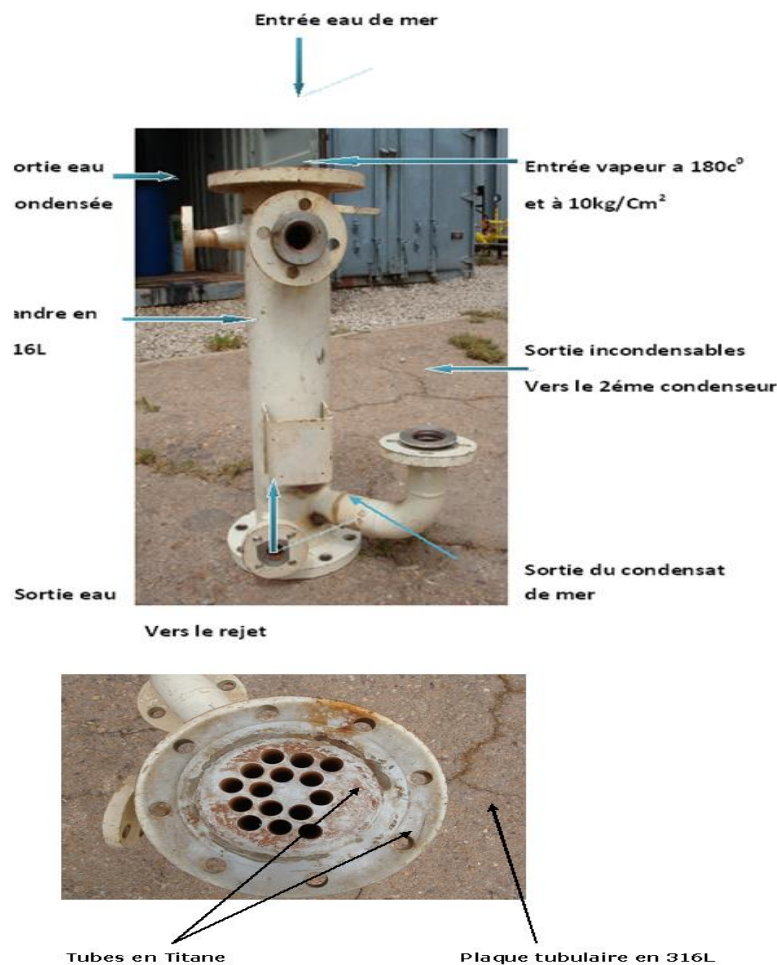
Fig IV.3 Description du condenseur d'éjecteur de maintien type 3T240 « SIDEM »
