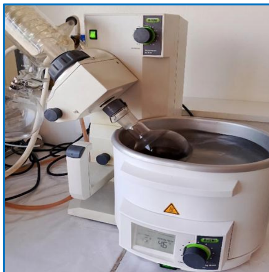
Figure 13 : Obtention de l'extrait fongique brut par évaporation rotative
