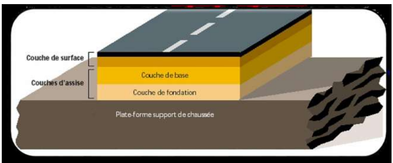
Figure II.2.1 : Les chaussées souples
