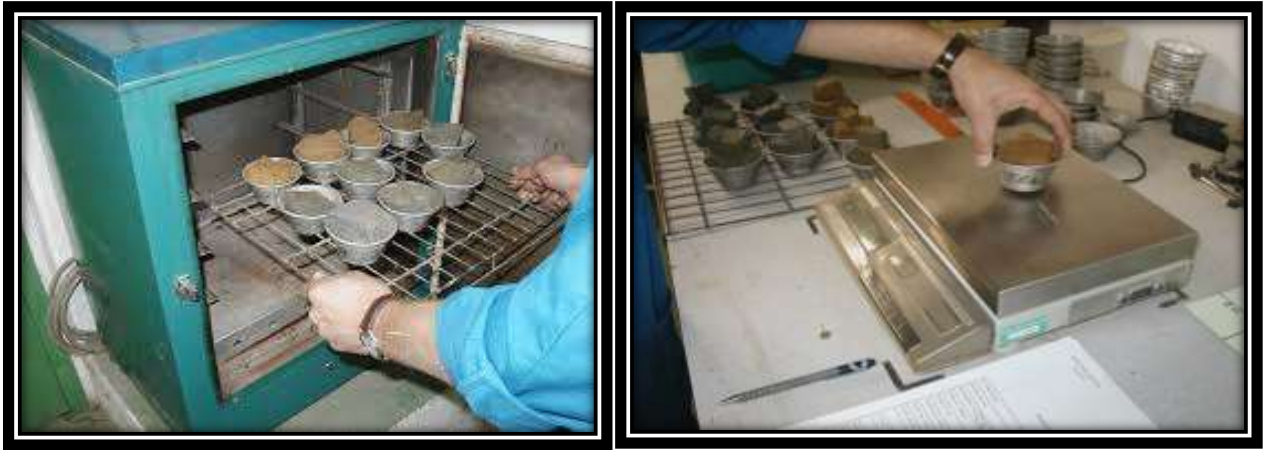
Figure 1 : Matériels d'essai teneur en eau
