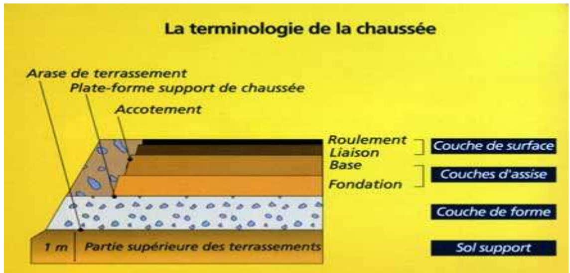
Figure VIII.4 : Terminologie d'une chaussée
