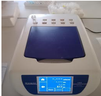
Figure 2. Spectrophotomètre de modèle UV-Visible Spectrophotomètre JENWAY 7205
