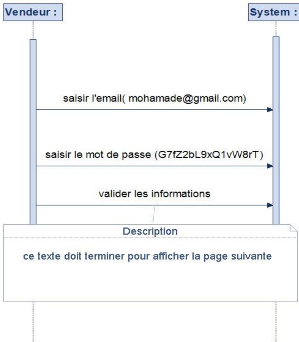
Figure 26 Diagramme de séquence de test 02 " Authentication".
