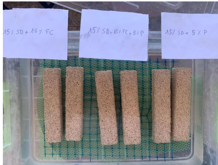
Figure II.11 Ré-immersion des éprouvettes dans une nouvelle solution d'acide ( H_2SO_4 )
