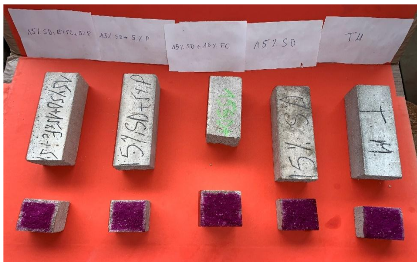
Figure II.13 Réaction des éprouvettes après application de la phénolphtaléine
