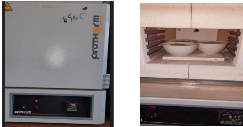
Figure II.2 Four de calcination utilisé (+ 1200°C) (25)
