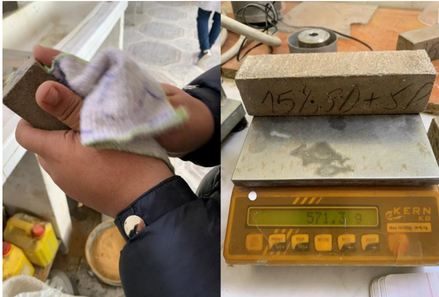
Figure II.7 (a) Essuyage des éprouvettes (b) masse initiale des éprouvettes
