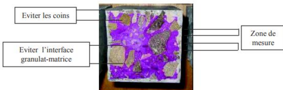
Figure II.14 Schéma illustrant le principe des mesures (32)
