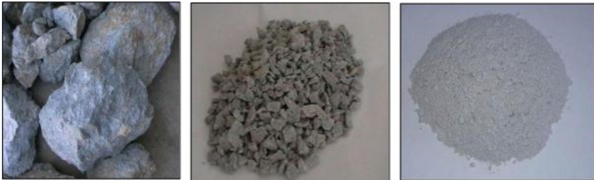
Figure I.5 Perlite naturelle (a), concassée (b), broyée (c)(14)
