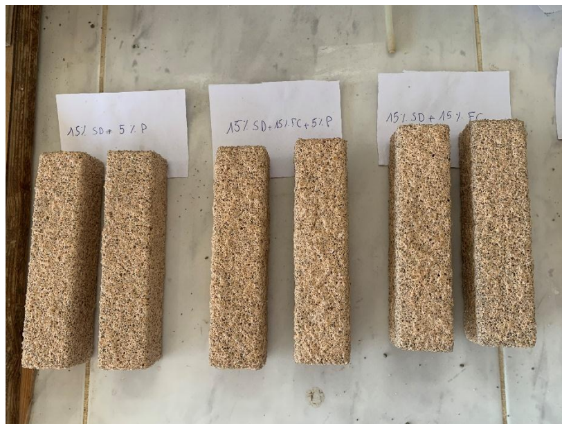
Figure II.10 Éprouvettes après retrait de la solution acide ( H_2SO_4 ) et en cours de séchage
