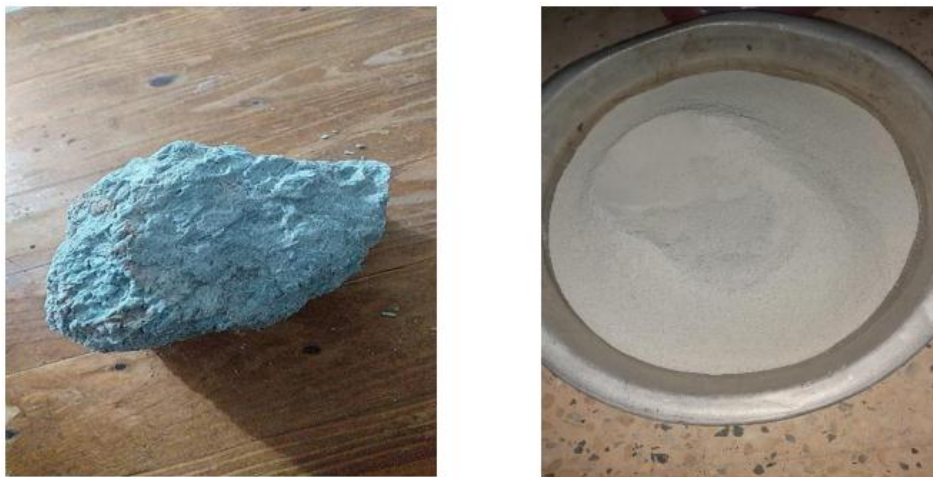
Figure II.3 (a) Roche de perlite naturelle avant broyage ; (b) Poudre obtenue après broyage) (25)
