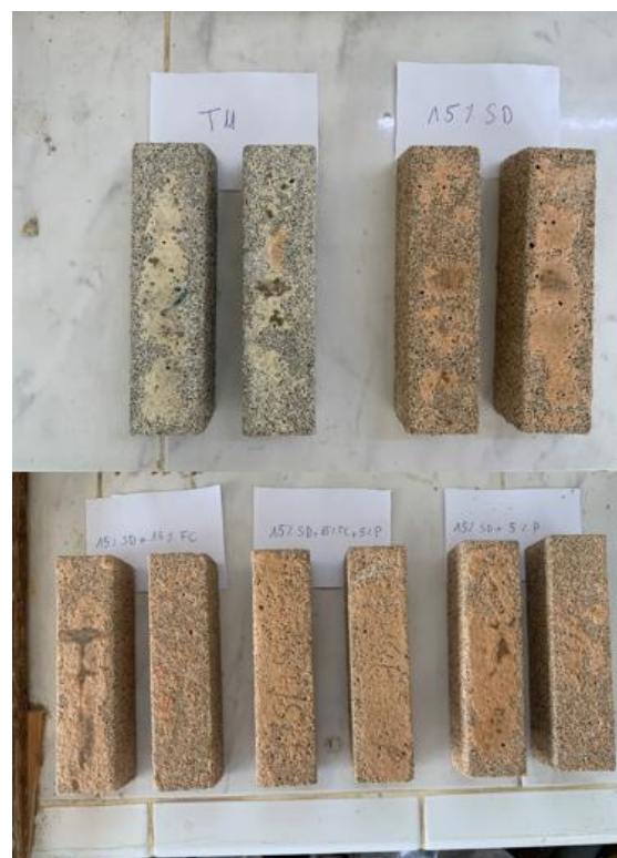
Figure II.16 Les éprouvettes après 1 semaine d'immersion dans la solution d'acide H_2SO_4
