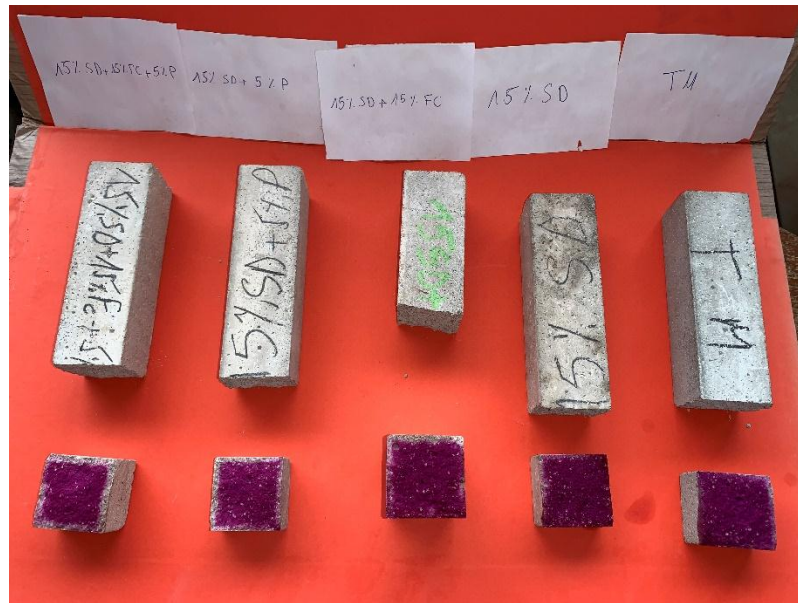
Figure II.19 Résultats visuels de carbonatation
