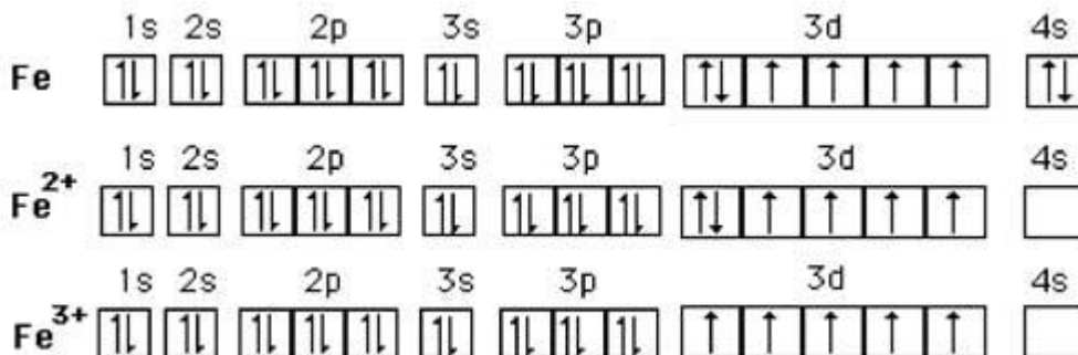
Figure I. 9 : Exemple d'orbitale 3d incomplètement remplie Fer (Fe)
