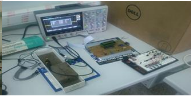
Carte d'interfacage du biocapteur à base de micro-contrôleur
