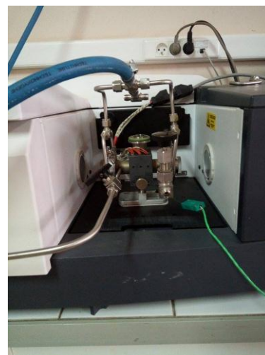
Cellule de mesure montée sur un IR
