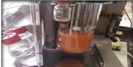
Production en masse de la bactérie halophile en Bioréacteur de 5L
