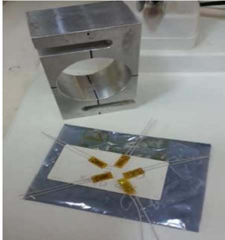
Corps d'épreuve après usinage et jauges de contraintes avant assemblage
