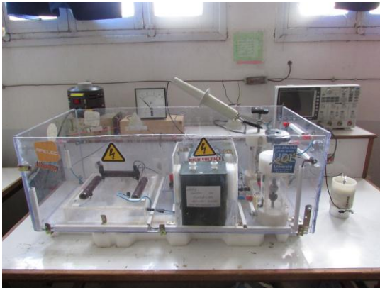
Banc de traitement par champ pulsé haute tension
