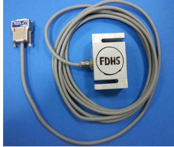
Produit fini : Capteur de Force 1kN (FDHS)
