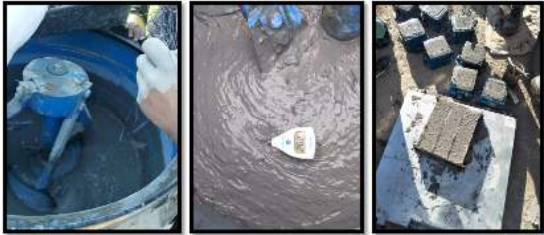
Figure II.2.19 : Les étapes de préparation du mélange 2
