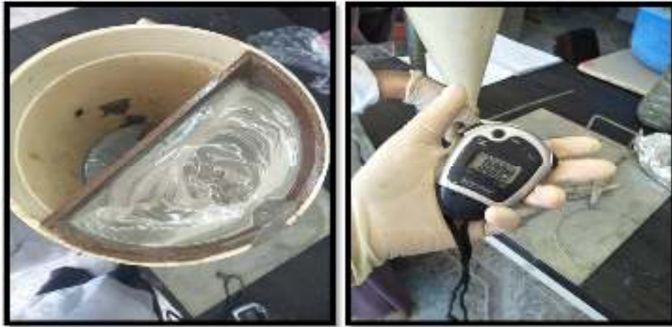
Figure II.2.14 : Remplissage du cône figure II.2.15 : Mesure le temps d'écoulement
