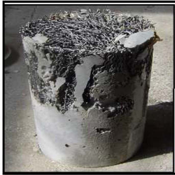
Figure I.3.3 : Un exemple d'échec de la préparation à cause de manque de fluidité de coulis
