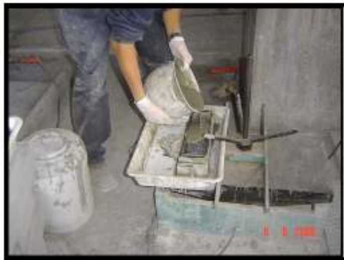
Figure I.3.2 : Infiltration de coulis aidée par des vibrations externes
