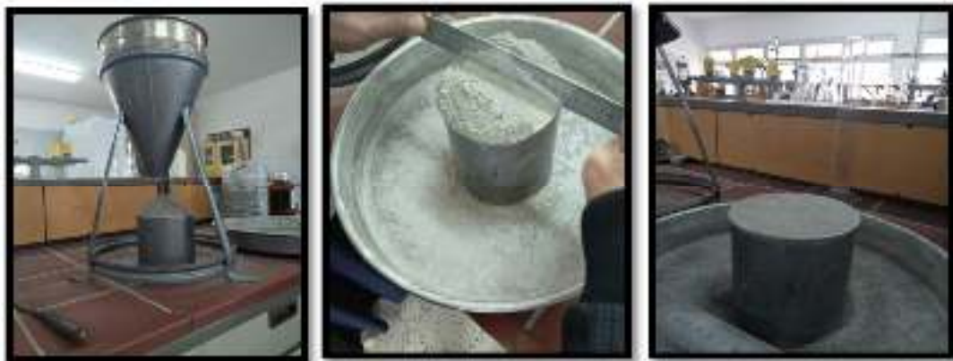
Figure II.2.2 : Procédure de mesure de la masse volumique apparente du ciment
