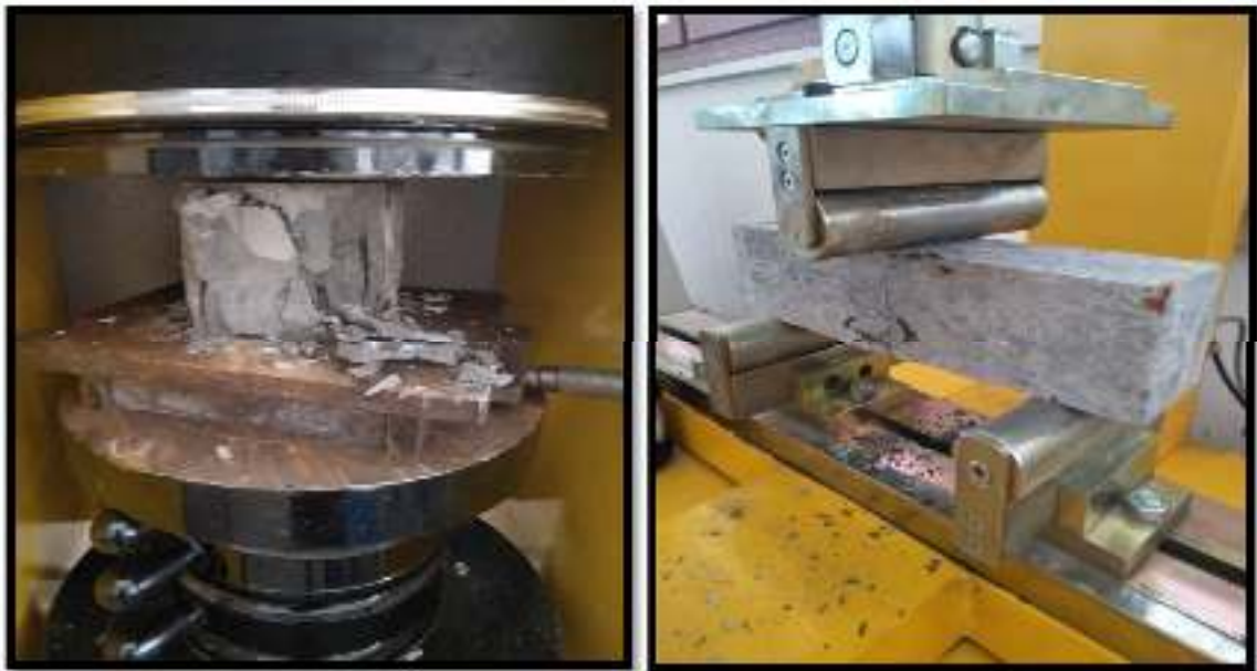
Figure III.3.1 : Processus d'écrasement des éprouvettes dans les presses
