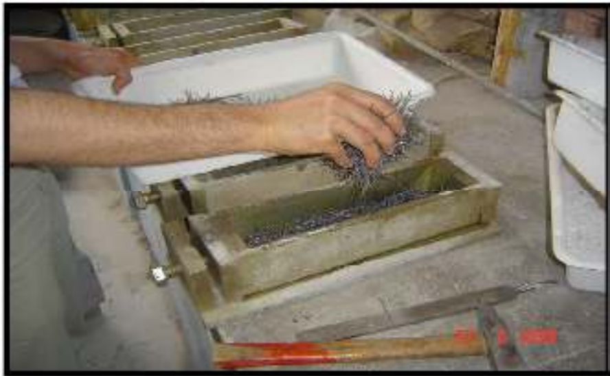
Figure I.3.1 : Placement à la main des fibres d'acier dans un moule
