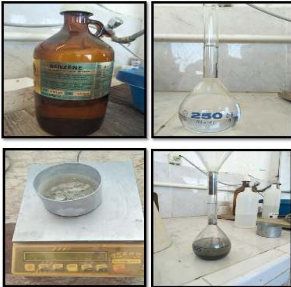
Figure II.2.1 : Procédure de mesure de la masse volumique absolue du ciment
