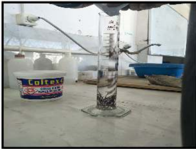
Figure II.2.5 : Mesure de la masse volumique des fibres
