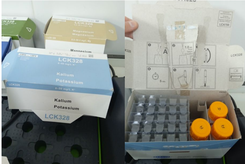
Figure 27: les tests en cuve de Potassium
