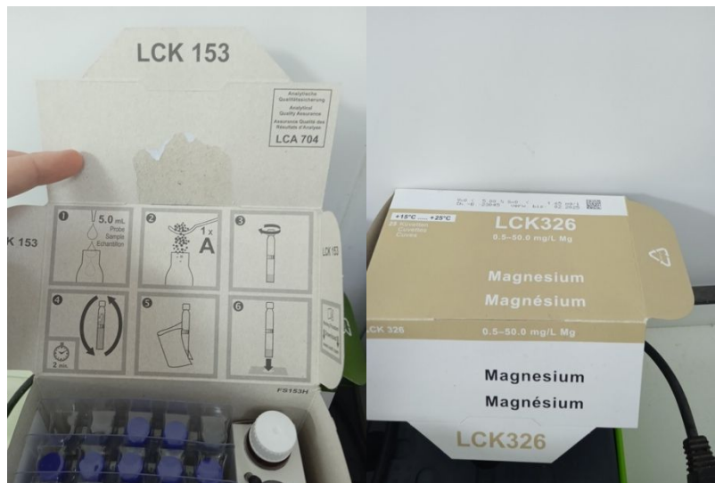
Figure 24: les tests en cuve de Magnésium
