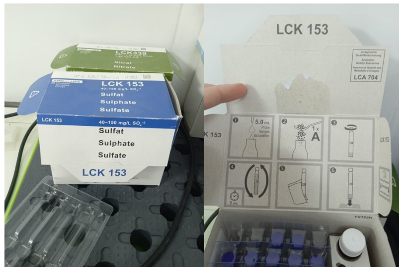
Figure 28: les tests en cuve de Sulfates
