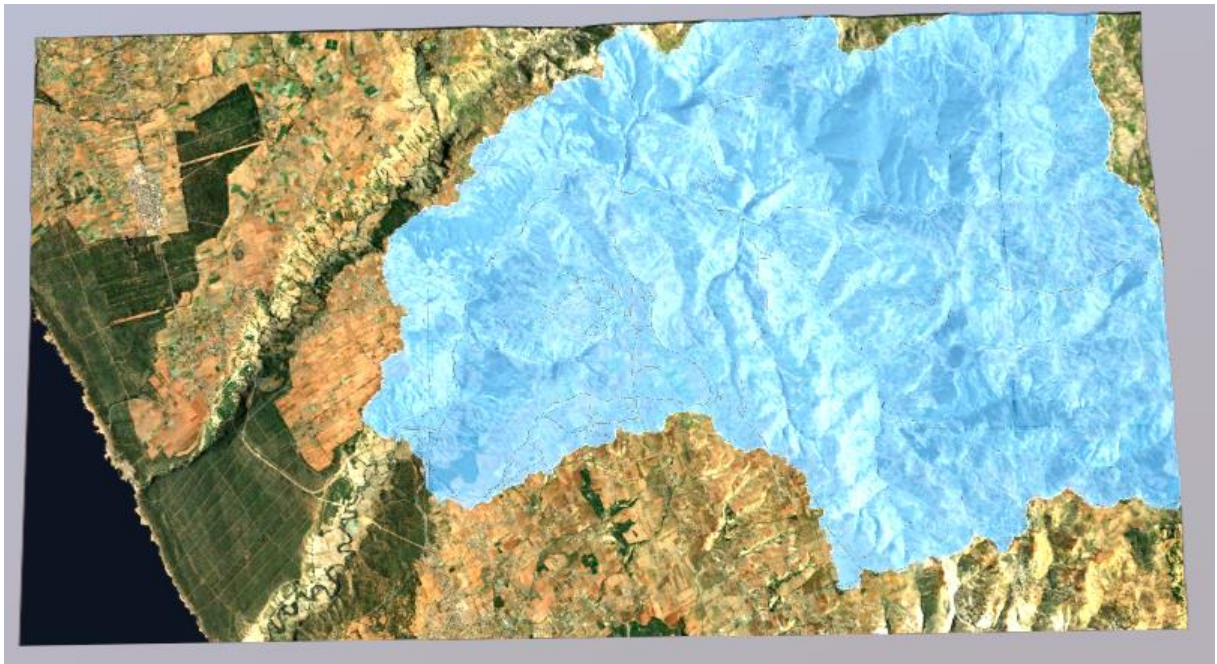
Figure 4-5 la délimitation de bassin versant sous INFRAWORKS.
