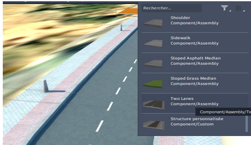
Figure 2-15 Remplacement de structure de la route.
