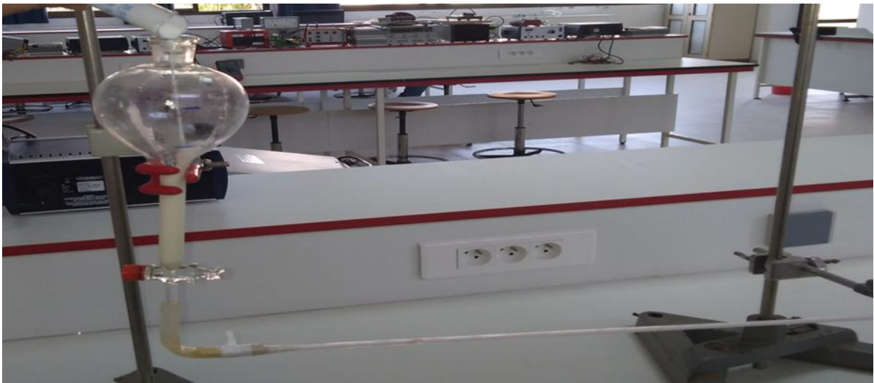
Figure16. Viscosimètre adapté à la mesure de la viscosité des laits fermentés.
