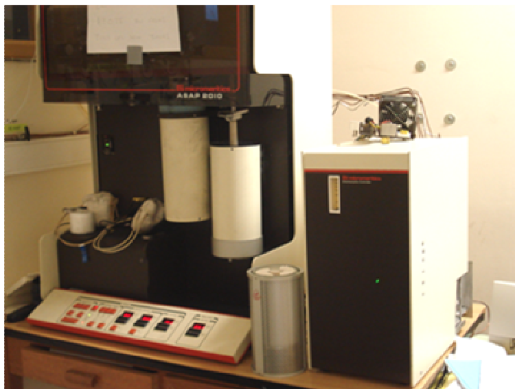
Figure 4 : appareil ASAP 2010 pour l'obtention des isothermes d'adsorption (Laboratoire AIME, Université Montpellier II)
