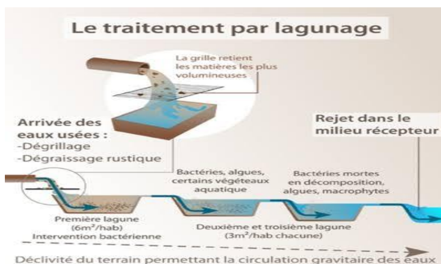
Figure II.4 : schéma de principe de système lagunaire. [29]
