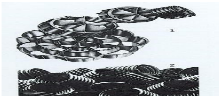
Figure II.9 : exemple de matériaux de remplissage en vrac [19].
