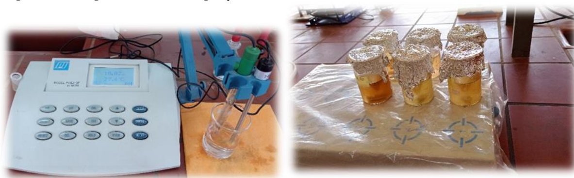
Figure 12 : Détermination de pH au point de charge zéro(nulle) d'un biosorbant.
