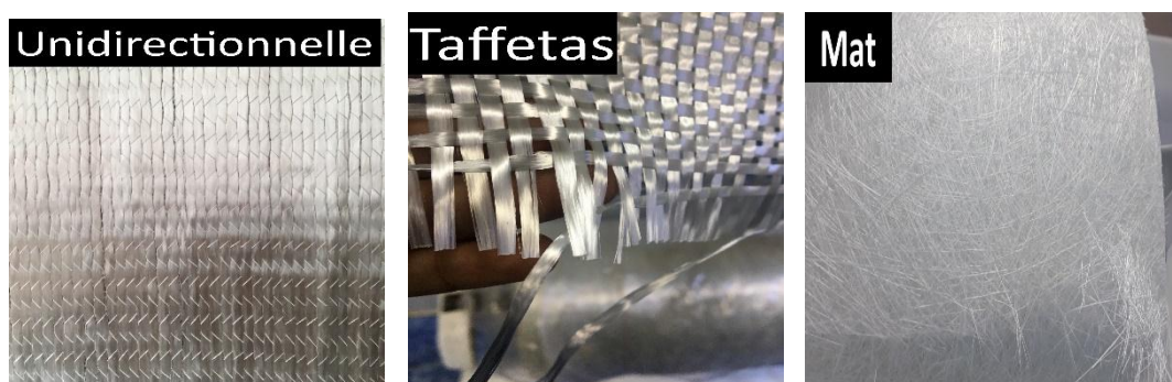
Figure I. 6. Représentation des types de fibres de verre
