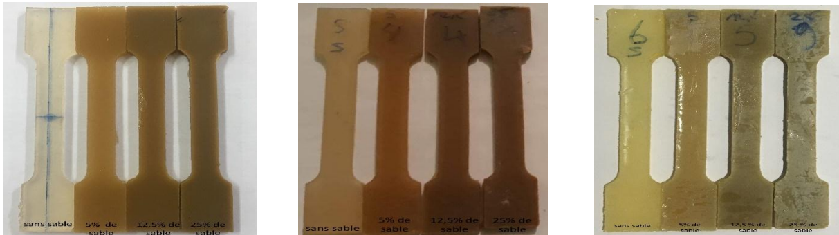
Figure II.15. Eprouvettes : a : non immergé dans l'eau..., b : immergé 5 jours (120 heures ) dans l'eau et c : immergé 10 jours (240 heures) dans l'eau.
