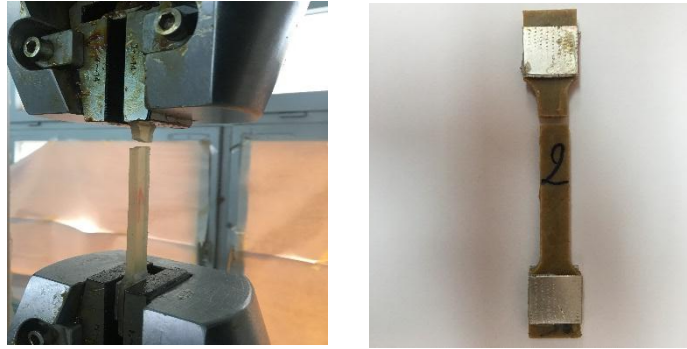
Figure II.17. Traction sur une éprouvette testée sans trous (cassée).
