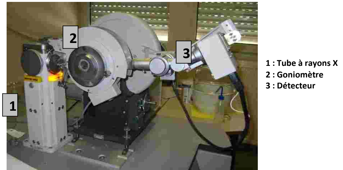
Figure I.7 : schéma représentatif d'un Diffractomètre de poudre (PW 3710)
